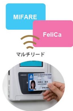
1台で非接触ICカードMIFARE、FeliCaの両方を使用できるマルチリード方式を採用しています。
